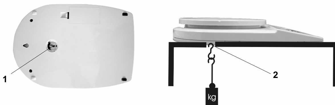
Výkres 1: Postavení váhy k vážení pod podlahou
